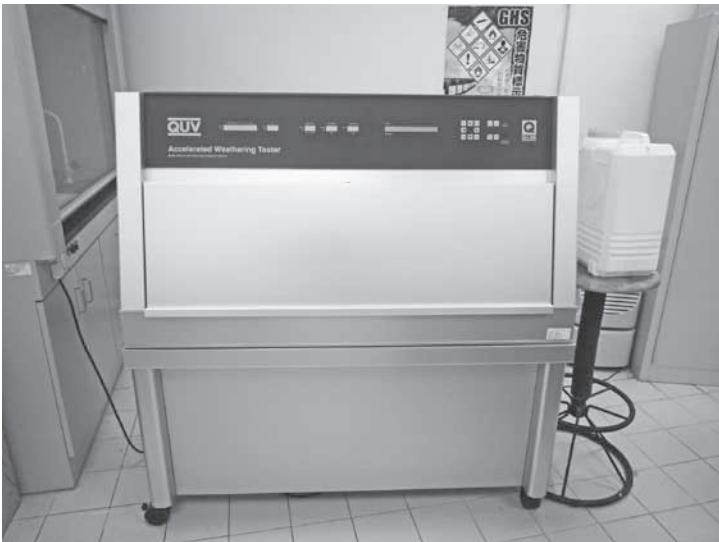
圖 17 QUV 加速耐候實驗機，筆者自攝。
