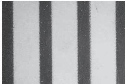
圖 52 Paraloid®B-48N 各添加 1%BTA+HALS 老化至 600hr 之外觀 (10x)，筆者自攝。
