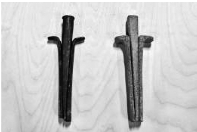
圖 44-4 由黑花崗岩製成的劈鑿與石材取樣實際使用的金屬製劈鑿。
